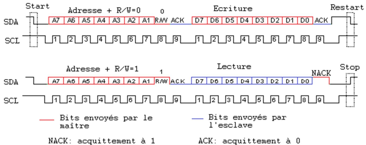
Figure 8 : Exemple de trames I2C
